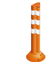
PF-N800-24 高さ 800mm ダイヤモンド「グレード」反射シート3枚 スタンダードタイプ 接着剤目安：300g（排水性舗装：360g）
