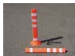
3～5年経過して汚れた状態
