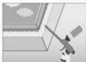
天窓の継ぎ目の充填、止水効果
