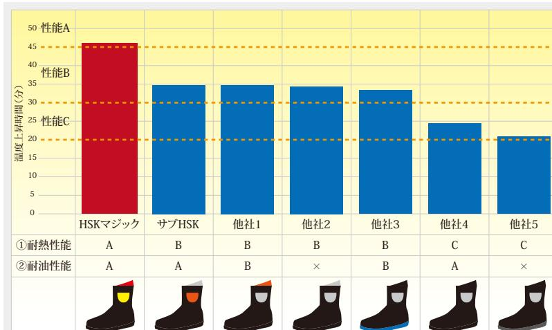
①耐熱試験: 150±5°Cのサンダルバスに靴を置き、靴内(踏み付け部)の温度が20±2°Cから22°C上昇するまでの時間を測定。性能A(区分2): 45分以上、性能B(区分2): 30分以上45分未満、性能C(区分1): 20分以上30分未満 (安全靴・作業靴技術指針: 高温耐熱性試験に準じる)
