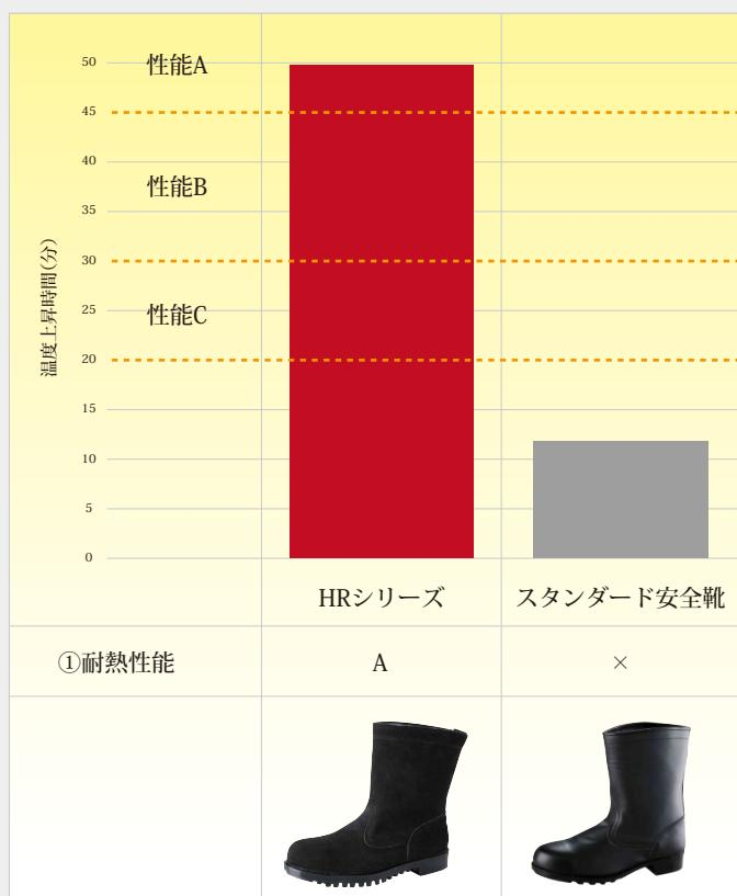
①耐熱試験：150±5℃のサンドバスに靴を置き、靴内（踏み付け部）の温度が20±2℃から22℃上昇するまでの時間を測定。
